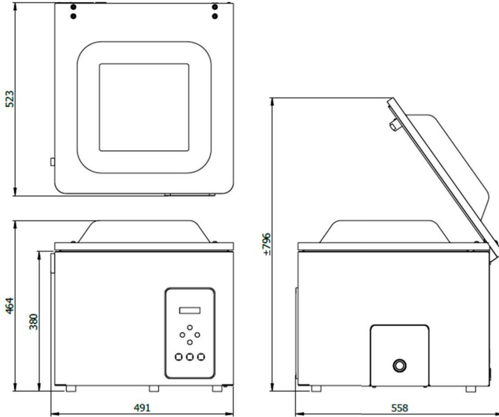
VACUUM PACKAGING MACHINE — AERO 42+ — SPEC SHEET
